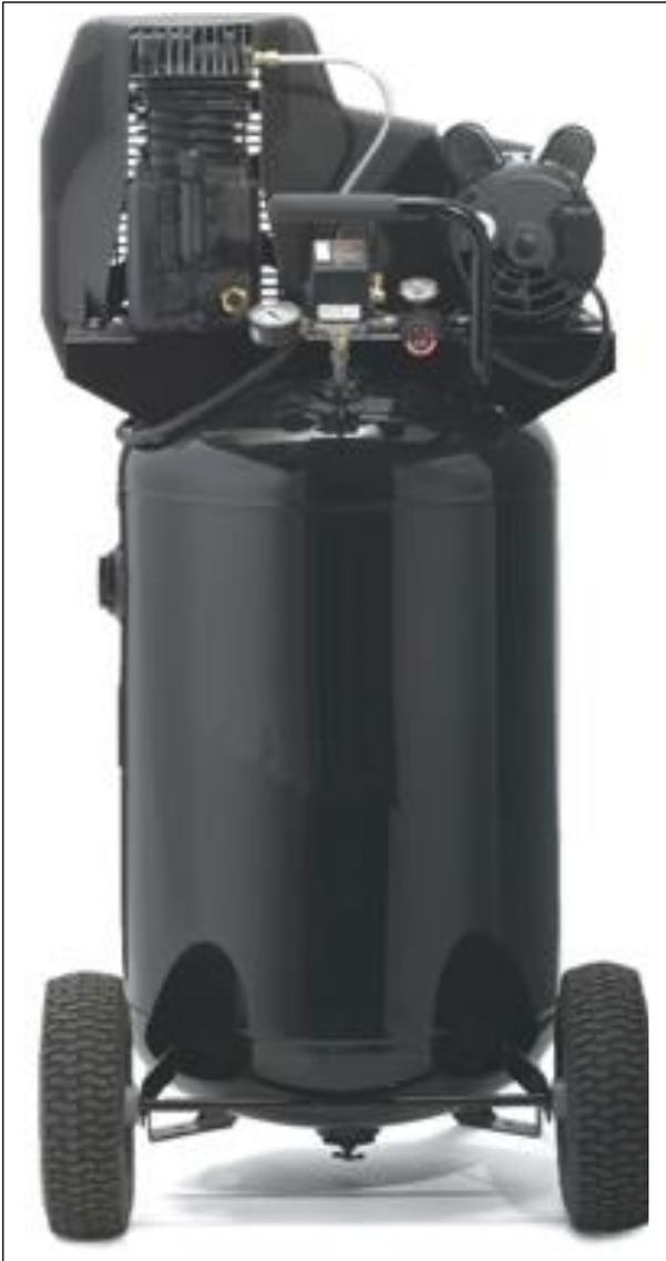
La pompe en fonte, à double cylindre et lubrifiée à l'huile comprend un carter en fonte monobloc, un corps de cylindre en fonte thermiquement stable, une tête en aluminium et des plaques de soupape en fonte usinée, des roulements à billes de style automobile, des soupapes à lamelles en acier inoxydable durable, un voyant de niveau d'huile, facilement remplissage d'huile accessible, volant moteur équilibré en fonte de 12"
